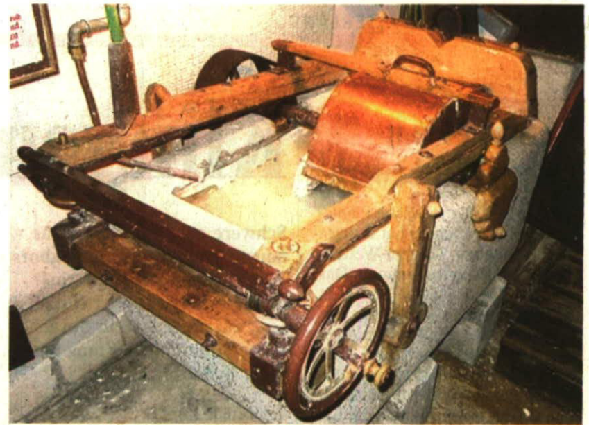
Nachbau eines Holländers nach Kupferstichen aus dem 18. Jahrhundert: Zu sehen in der Steinort Papyr Mühl, Triesenberg. Bild pd
