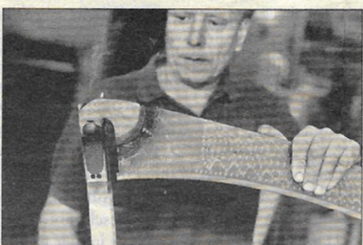
...danach richtet Vittorio Brunelli das immer noch glühende Blatt am Worb, zu guter Letzt misst er mit einer Eisenstange, ob der Winkel stimmt.
